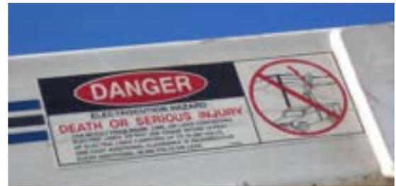
**SURVEY ALL WORK AREAS FOR OVERHEAD POWER LINES BEFORE LIFTING ANY DUMP BEDS OR CRANE BOOMS.**
